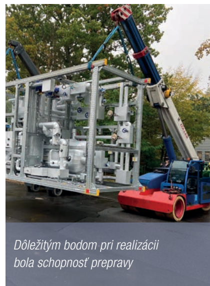
Vďaka skrutkovým spojom sú zmeny možné kedykoľvek
